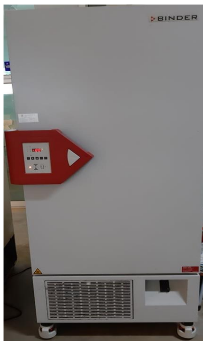
ภาพที่ 2.9 ตู้แช่แข็งอุณหภูมิต่ำ (-80 °C)
