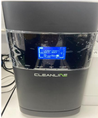
รูปที่ 34 แสดงเครื่องสำรองไฟ
