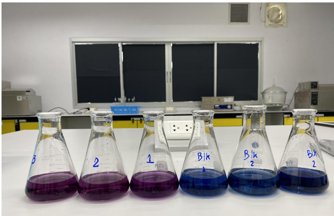
ภาพที่ 4 สีของสารละลายเมื่อเติมสารละลายบัฟเฟอร์ pH 10 และ Eriochrome Black T
