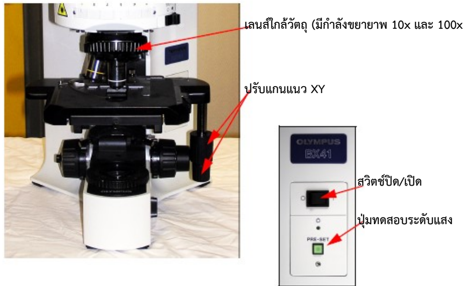
รูปที่ 2.7 เครื่องมือ XploRA กับไมโครสโคปรุ่น BX41 ปรับแกนด้วยมือ
