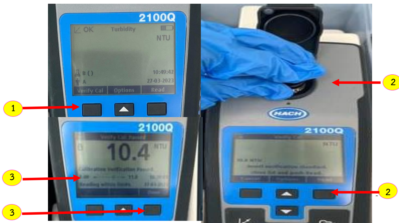
ภาพที่ 6 ขั้นตอนการ Verify Cal. ด้วยสารละลายมาตรฐานฟอร์มาซิน ความเข้มข้น 10 NTU
