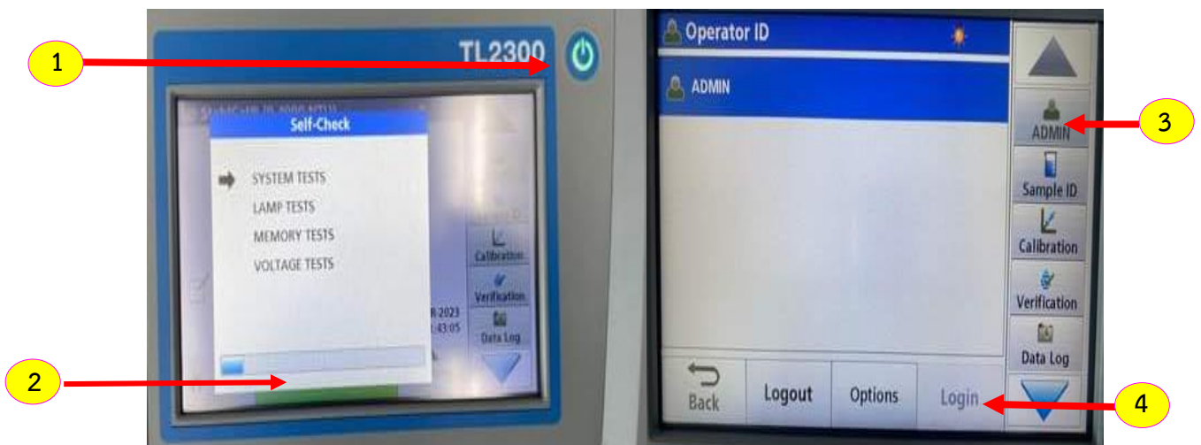
ภาพที่ 11 ขั้นตอนการเปิดเครื่องวัดความขุ่น ชนิดตั้งโต๊ะ
