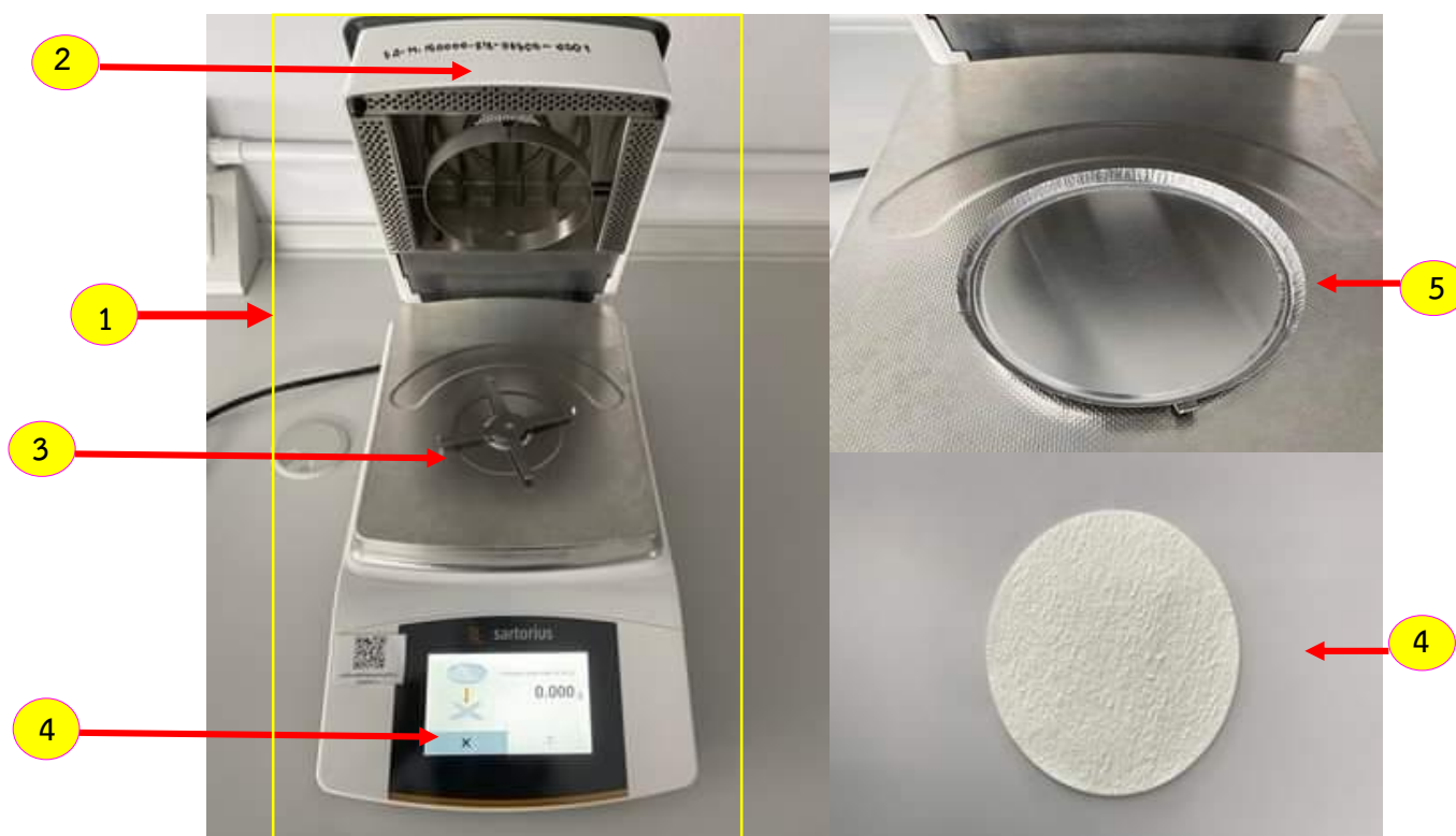
ภาพที่ 18 ส่วนประกอบของเครื่องวิเคราะห์ความชื้น (Moisture Analyzer)
