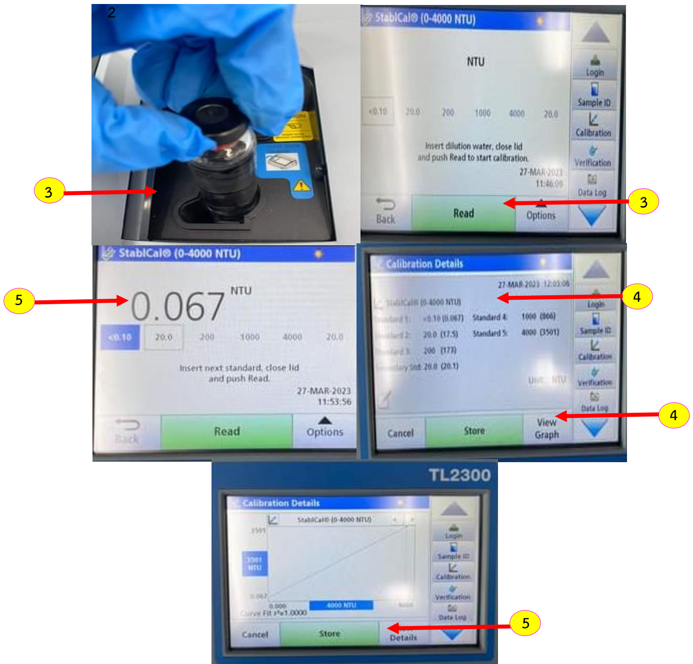
ภาพที่ 13 ขั้นตอนการ Calibrate ด้วยสารละลายมาตรฐานฟอร์มาซิน ความเข้มข้น 20 NTU, 200 NTU, 1,000 NTU และ 4,000 NTU (ต่อ)
