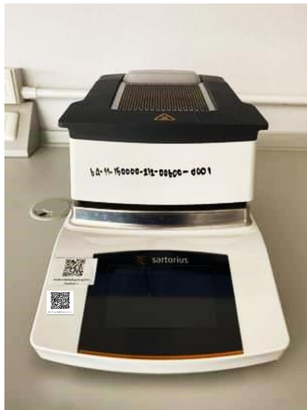
ภาพที่ 17 เครื่องวิเคราะห์ความชื้น (Moisture Analyzer)
