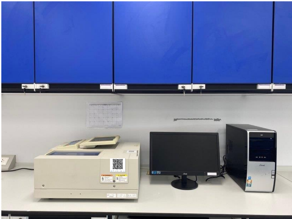
ภาพที่ 1 เครื่องยูวี-วิสิเบิลสเปกโตรโฟโตมิเตอร์ (UV-Vis spectrophotometer)
