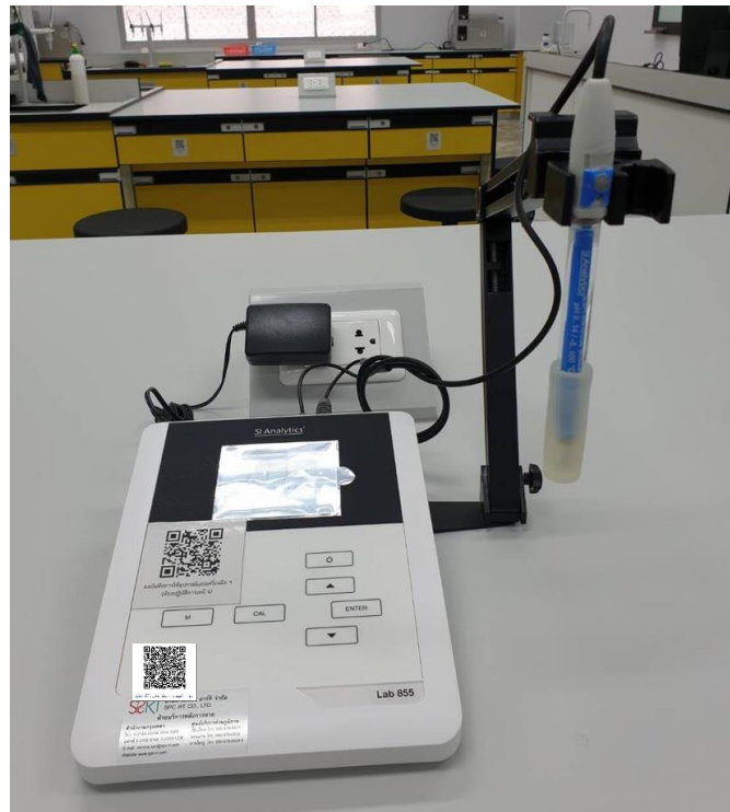
ภาพที่ 10 เครื่องวัดความเป็นกรด-ด่าง ชนิดตั้งโต๊ะ (pH Meter)
