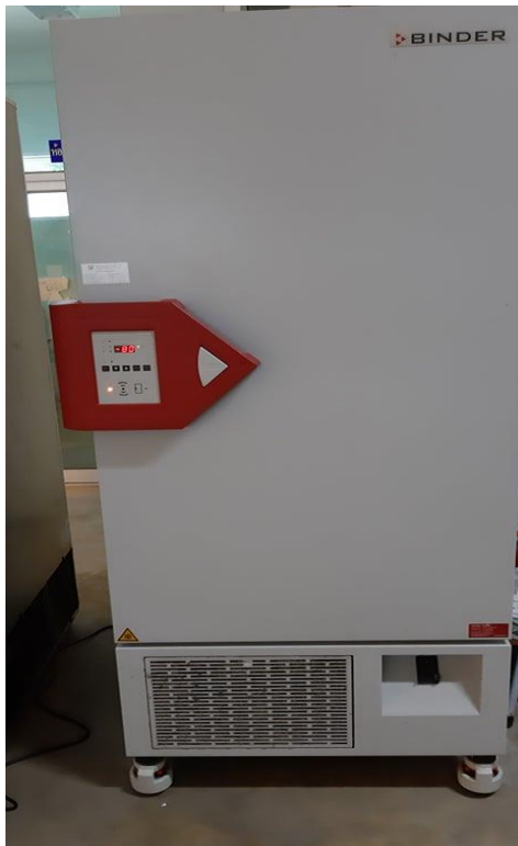
ภาพที่ 2.10 ตู้แช่แข็งอุณหภูมิต่ำ (-80 °C)
