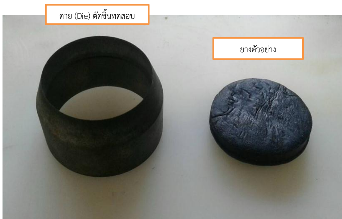
รูปที่ 34 ดาย (Die) ตัดขึ้นทดสอบ และยางทดสอบ
