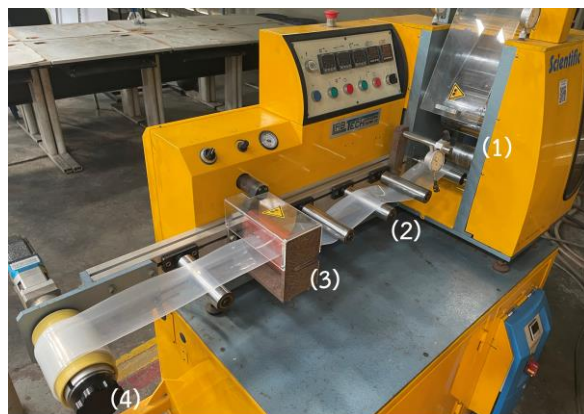
รูปที่ 4.10 อุปกรณ์ประกอบหลังการอัดรีดแผ่นพอลิเมอร์
