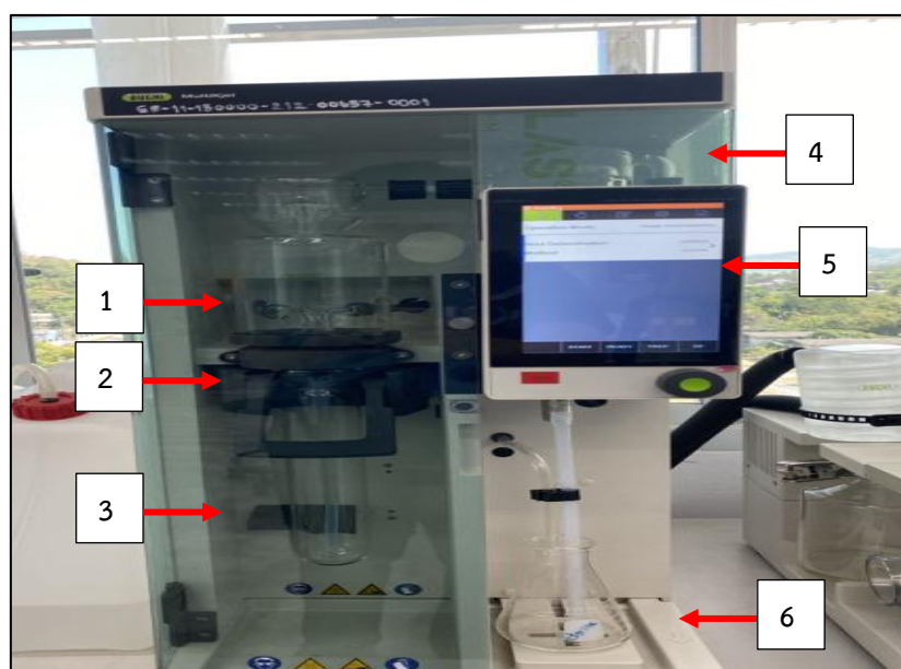
ภาพที่ 4 ส่วนประกอบภายในของเครื่องกลั่น
