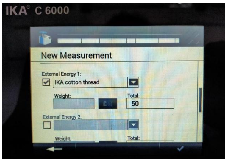
รูปที่ 23 ตัดค่าพลังงานของด้ายจู่ระเบิด (Firing cotton)
