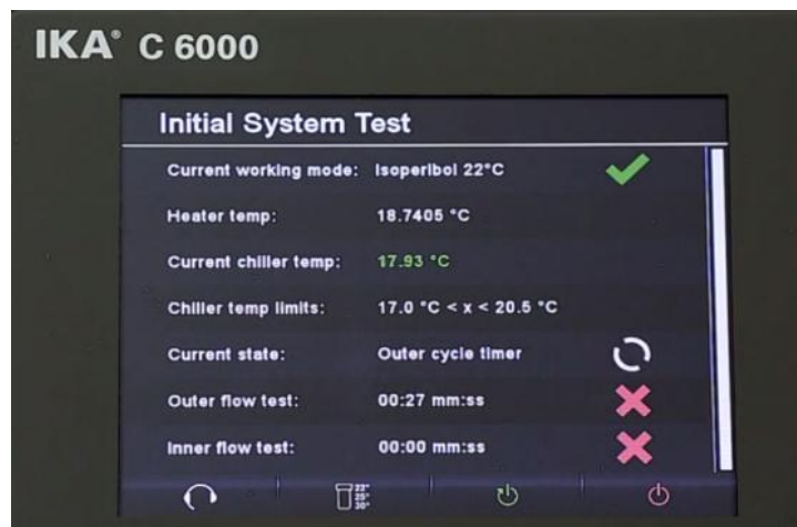
รูปที่ 14 หน้าจอ ตรวจเช็คคุณสมบัติของน้ำหมุนเวียนให้อยู่ในช่วงที่กำหนดก่อนการเผาไหม้จริง
