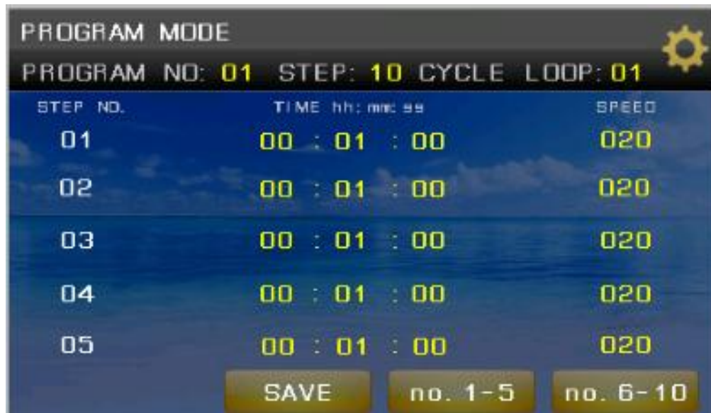
รูปที่ 6 การตั้งค่าโหมดโปรแกรมโหมด (Program Mode)
