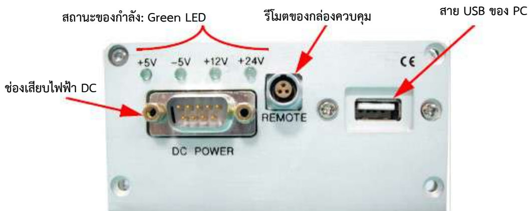
รูปที่ 1.7 แสดงตำแหน่งการเชื่อมต่อของด้านหลังแผงควบคุม
