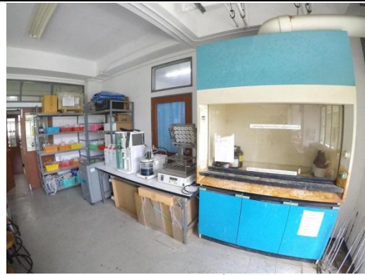
ตู้ควบคุมอากาศและเครื่องไนโตรเจน
